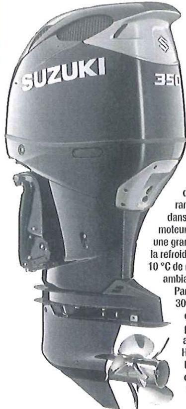
Dévoilé l'an dernier, le DF 350A est le plus récent de nos trois compétiteurs. Le V6 calé à 55° offre une cylindrée de 4,4 litres et fonctionne à un taux de compression de 12/1, le plus élevé actuellement sur le marché. Le DF 350 Intègre de nombreuses nouveautés. Le système d'admission d'air est doté de deux rangées d'ailettes dans le capot moteur, ce qui permet d'aspirer une grande quantité d'air tout en la refroidissant à en moyenne 10 °C de moins que la température ambiante.
