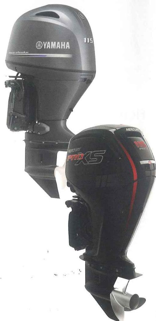
...ple 2,5 secondes de plus au Yamaha pour franchir la barre des 30 nœuds. Cela s'équilibre au niveau de la vitesse maximale avec un avantage de seulement 0,2 nœud en pointe pour le Mercury, mais 200 tours de moins, peut-être un problème d'hélice.
